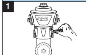
Schrauben am Spannring lösen
