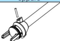
Togliere l'asta di comando, sostituire il cono, riporre nella guida l'asta
