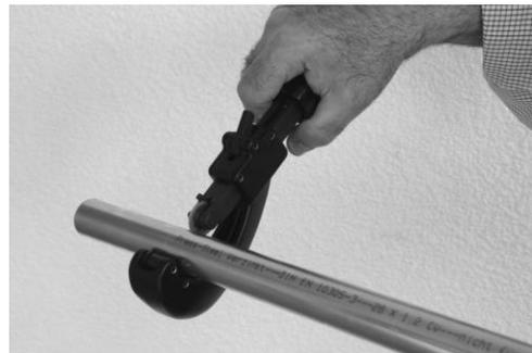
Nach dem Trennvorgang der Edelstahlrohre müssen die Rohrenden innen wie außen mit einem handelsüblichen Rohrendgraten für Edelstahl/ oder einer geeigneten Feile bearbeitet werden. Dies dient der Sicherheit beim Einführen des Rohrabschnittes in die Pressfittings, da sonst der Dichtring beschädigt werden kann.
