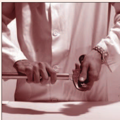
Fig. 22 Sbavatura dell'estremità dei tubi Pipe-end deburring
