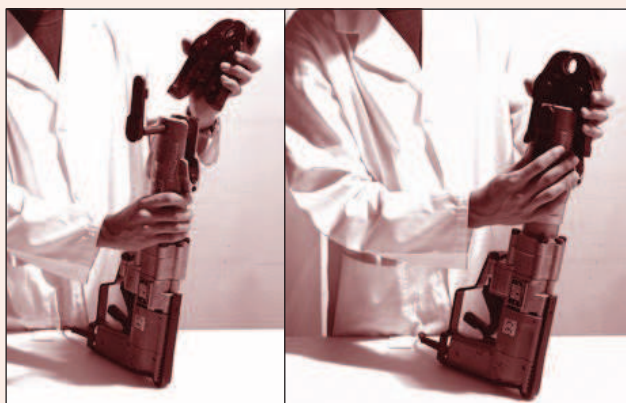
Fig. 27 Attrezzaggio delle pressatrici Pressing tool assembly
